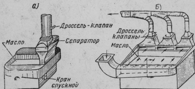
Фиг. 272. Схема местной вентиляции у закалочных ванн.
