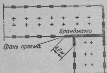
Фиг. 61. Расположение брандмауера в пересекающихся стенах.
