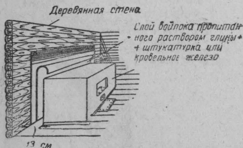
Фиг. 112. Отступ с защитой деревянной стены.
